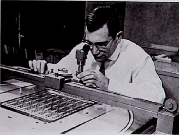
Voorbereiding van gedrukte schakelingen, m.b.v. een coördinatograaf met een nauwkeurigheid van 0,01 mm.
